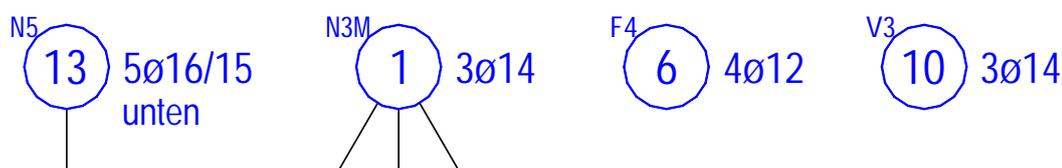
Die angezeigten Daten links oben zeigen den Typ der Bezeichnung und die gezählten Stück an. z.B. F 4 - bedeutet freie Bezeichnung, 20 gezählte Stück. Ist die Stückzahl größer 0 wird dieser Zusatztext in der Layerfarbe angezeigt, ist die Stückzahl 0 wird die Farbe „cyan“ verwendet. Es gibt die nachfolgend aufgelisteten Kurzzeichen:
