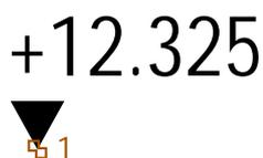
**Objektfang 1** (BASISPUNKT) fängt den Einfügepunkt der Höhenkote.
