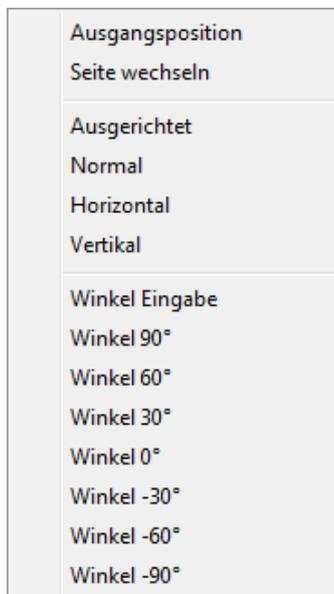
Die Option **Ausgangsposition** setzt einen verschobenen Bezeichnungstext wieder auf die Ausgangsposition zurück.
